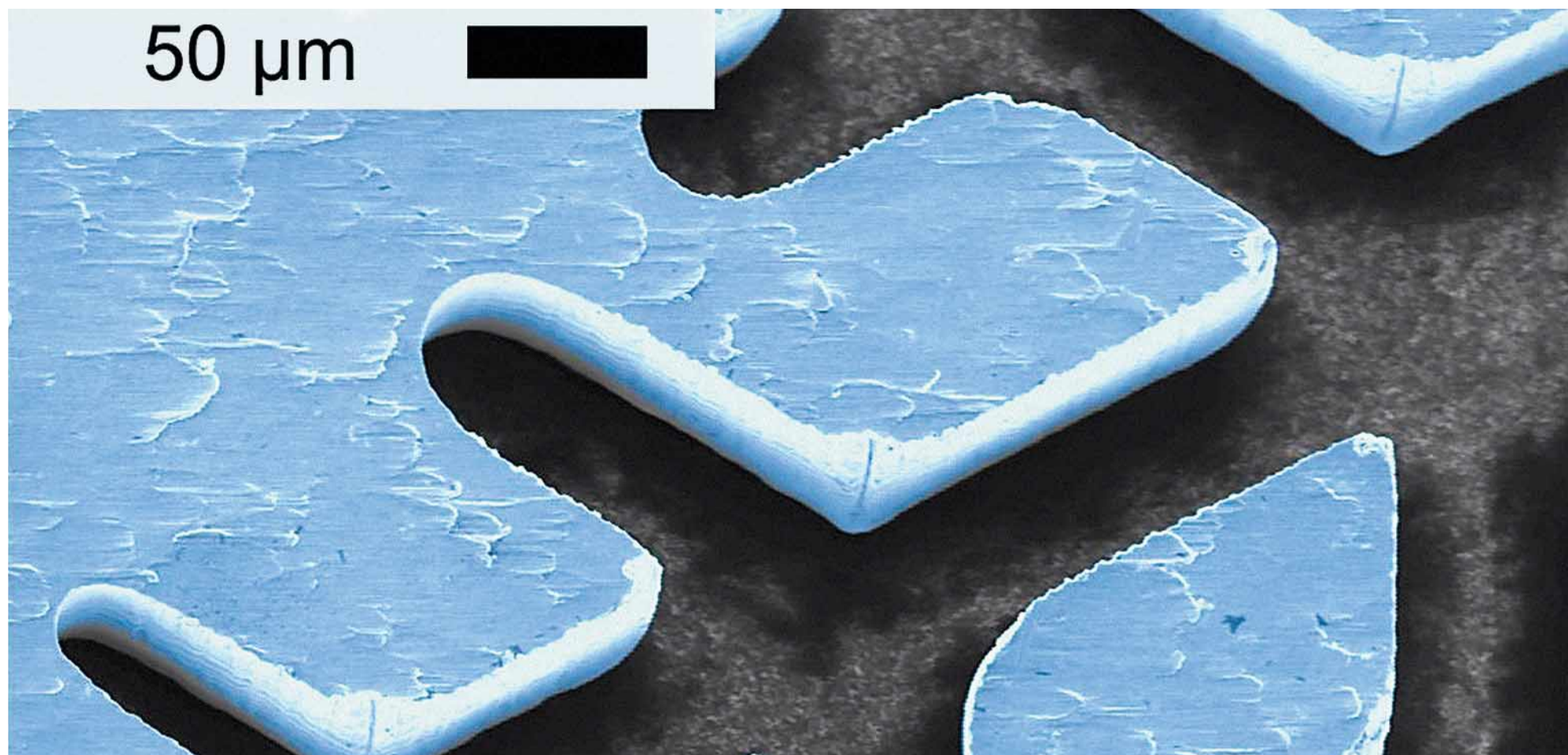
Arbeit einer Kleinmaschine, stark vergrößert: Ein Lumera-Laser bearbeitet eine winzige Schneeflocke, ohne dass dabei aufgeworfene Schmelzränder entstehen. Hersteller ist das Unternehmen Lumera-Laser aus Kaiserslautern. Rechts unten die Vergrößerung einer einzelnen Flocke
